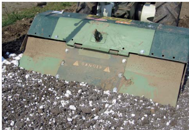
... und danach mit einer Umkehrfräse etwa 15 cm tief in den Boden eingefräst.
