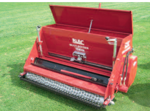
Professionelle Sämaschinen, welche die Samen in konische Bodenvertiefungen ablegt und mit einer Walze andrückt.
